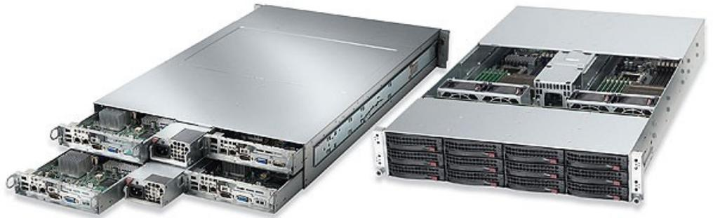
VXPRO R2800 は、2Uサイズの筐体に最新のインテル Six-Core/Quad-Core Xeonプロセッサを8台搭載可能なサーバシステムです。VXPRO R2800 は、一般的な1Uサーバに搭載されているサーバボードを半分のサイズに集約し、そのサーバボードを4台搭載する最新のサーバシステムです。これによって、8プロセッサ（24コア又は48コア）を2Uサイズでご提供可能です。このサーバは、標準の19インチラックに搭載可能です。
