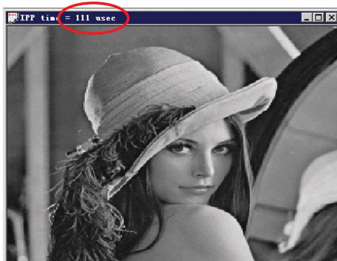
図 12: この画像サイズの変更例 (256x256 ビットから 460x332 ビット) では、インテル® IPP を使用したアプリケーションが 111 マイクロ秒であるのに対し、コンパイル済み C++ コードでは 338 マイクロ秒を要しています (システム構成: インテル® Xeon® プロセッサ、2.9 GHz、2 プロセッサ、4 コア/プロセッサ、2 スレッド/プロセッサ)
