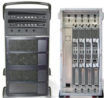
プロセッサとチップセットの選択が可能なブレード構成
