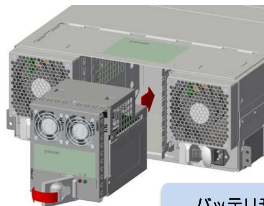
バッテリーモジュール
